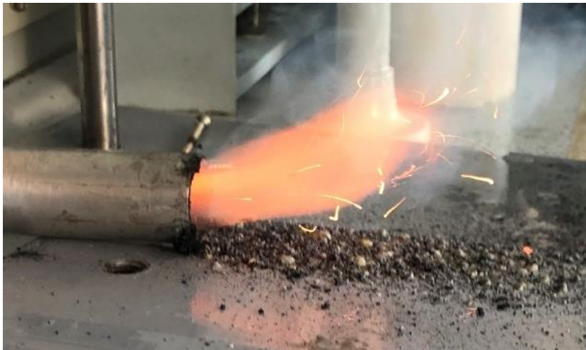
Abb. 11: Flamme des Boraxtriebwerkes
