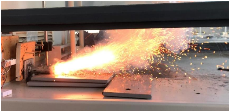
Abb. 17: Flamme des Kaliumchlorattriebwerkes
