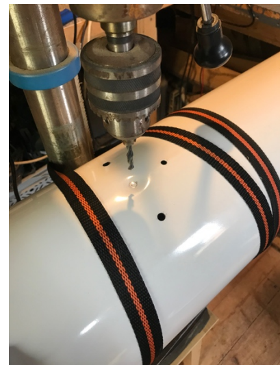
Abb. 12: Bohrung durch das Teleskoprohr
